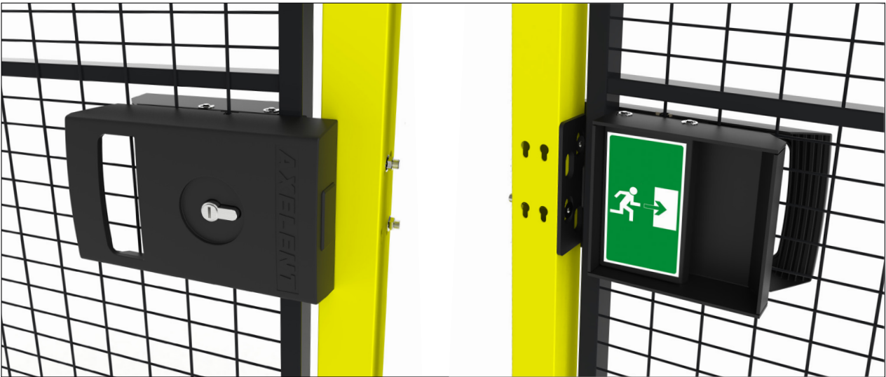
Zamek z możliwością otwierania awaryjnego X-It Zamek bębnekowy może być używany w wyjściu awaryjnym oraz ewakuacyjnym tam, gdzie wymagany jest dostęp do celów konserwacji. Drzwi wyposażone w zamek z możliwością otwierania awaryjnego można zawsze otworzyć od środka, nawet jeśli są od zewnątrz zamknięte na klucz.
